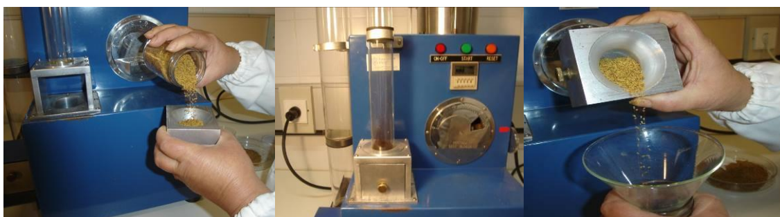
Figura 7 - Limpeza de sementes com recurso ao Seed blower .
